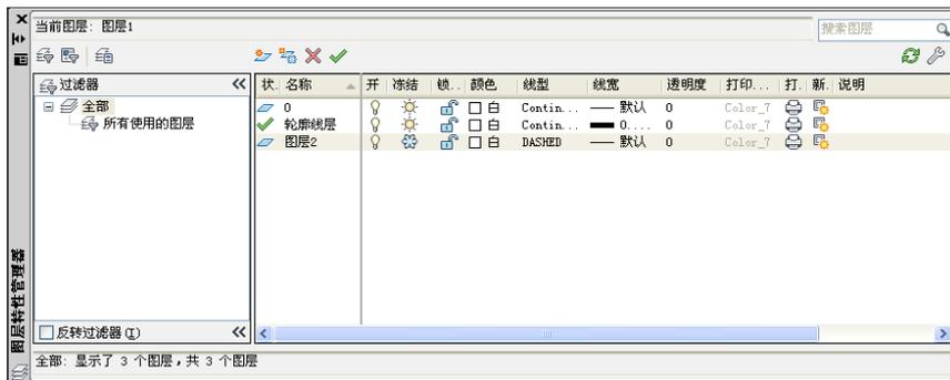
单击【图层】面板上的图层特性按钮，打开如上图所示【图层特性管理器】对话框进行图层创建。
